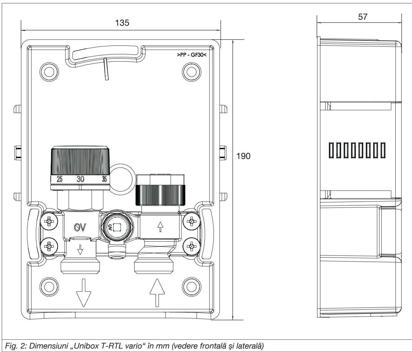
Fig. 2: Dimensiuni „Unibox T-RTL vario“ în mm (vedere frontală și laterală)
