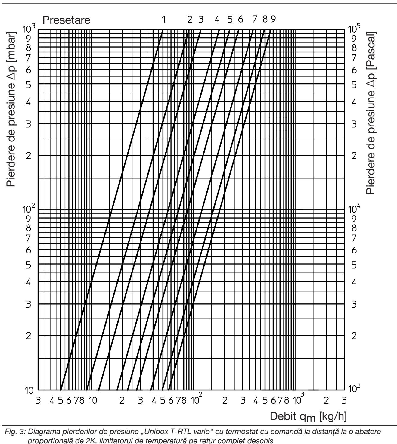
Fig. 3: Diagrama pierderilor de presiune „Unibox T-RTL vario“ cu termostat cu comandă la distanță la o abatere proporțională de 2K, limitatorul de temperatură pe retur complet deschis
