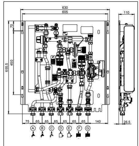
Fig. 4.4 Dimensioni con circuito di riscaldamento miscelato
