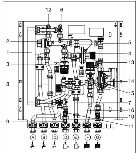
Fig. 5.2 Conception avec circuit de chauffage mélangé
