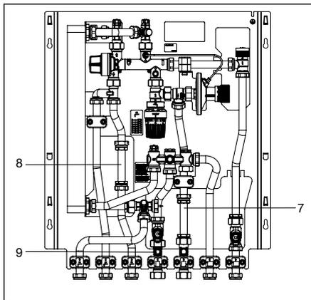
Fig. 6.1 Installazione contatore acqua fredda e contacalorie
