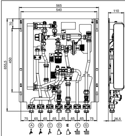
Fig. 4.2 Encombres avec circuit de chauffage direct
