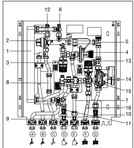
Fig. 5.2 Installazione con circuito di riscaldamento misto
