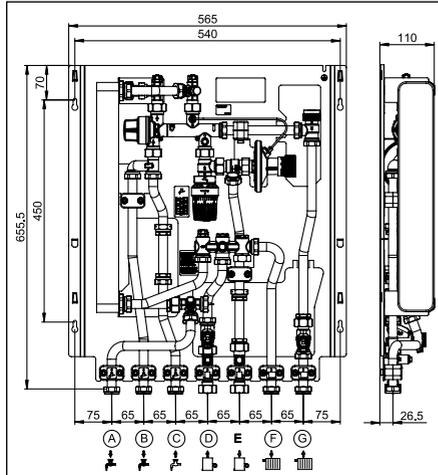
Fig. 4.2 Dimensioni con circuito di riscaldamento diretto
