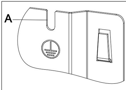
Abb. 7.1 Schutzpotentialausgleich/Erdung
