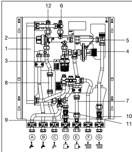
Fig. 5.1 Conception avec circuit de chauffage direct
