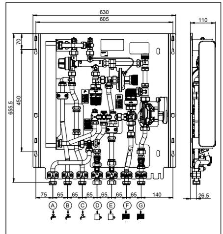
Fig. 4.4 Encombres avec circuit de chauffage mélangé
