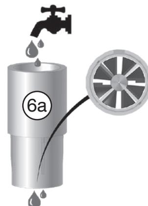
Abb. 5.18: Messturbine unter fließendem Wasser reinigen
