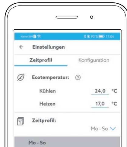
Abb. 16: ClimaCon F App Ecotemperatur einstellen
