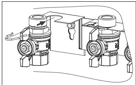
Den Kugelhahn in die Aufhängung der Anschlussleiste einhängen.
