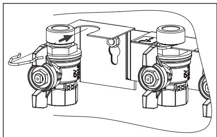
Suspendre le robinet à tournant sphérique au bloc de raccordement.
