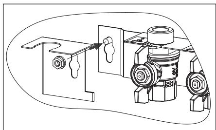
Das Halteblech wird mit der Aufhängung der Kugelhahnleiste der Wohnungsstation (Art.-Nr.: 1341180) an der Grundplatte mit befestigt (Schrauben und Muttern der vorhandenen Anschlussleiste mit benutzen).
