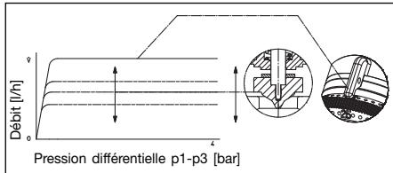
Fig. 5.6 Ligne caractéristique du débit pour préréglages différents
