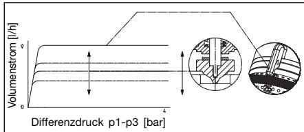
Abb. 5.6 Volumenstromkennlinie für unterschiedliche Voreinstellungen
