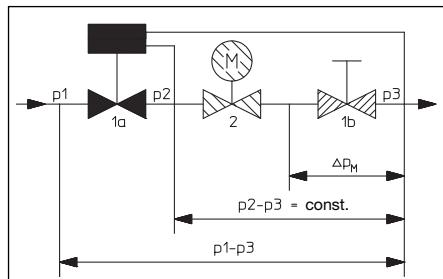
Fig. 5.3 Principe de fonctionnement «Cocon QTZ»
