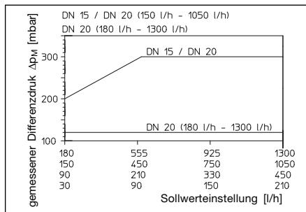
Abb. 5.1 Differenzdruck / Sollwertestellung
