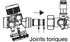
4. Monter le joint et serrer l'écrou de serrage
