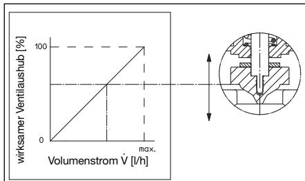
Abb. 5.4 Kennlinie der Reguliereinheit des „Cocon Q“
