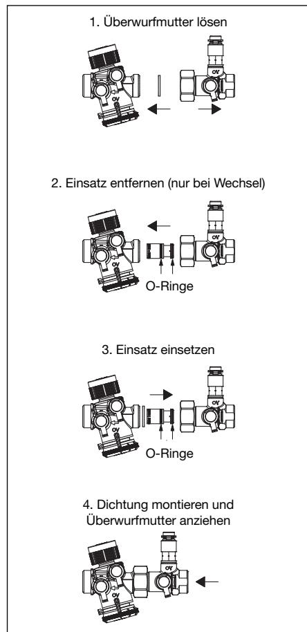
Abb. 6.3 Messblendeeneinsatz wechseln
