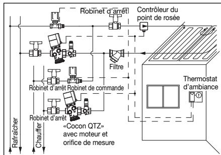
Fig. 6.2 Système à quatre tuyaux
