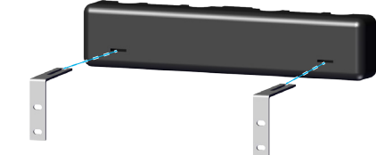
Fig. 4: Position des supports muraux
