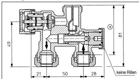
\* 66 mm für St. bzw. Cu-Rohr Ø 12 - 16 mm
