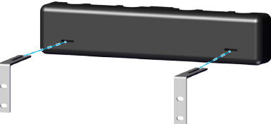
Fig. 4: Position des supports muraux
