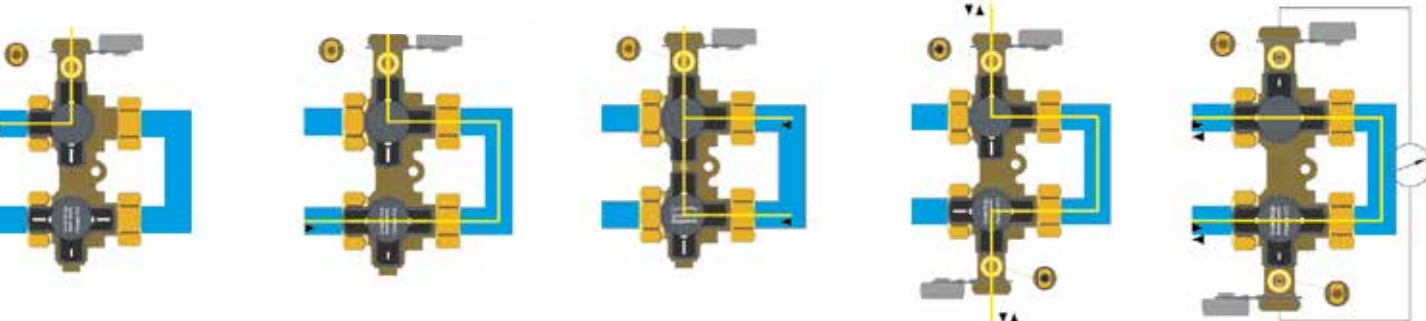
Entleeren, entlüften und spülen der Anlagenseite
