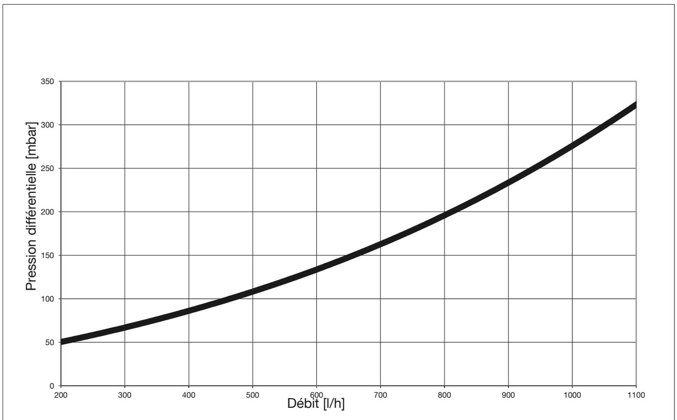
Fig. 5: Perte de charge circuit secondaire Regudis H
