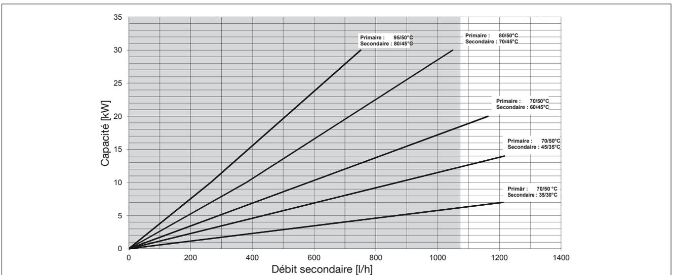
Fig. 8: Diagramme des puissances ; débit max. recommandé Regudis H en combinaison avec Regumat M3
