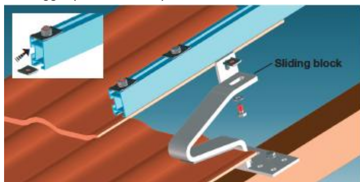
Illustr. 7: Fissaggio delle guide di montaggio
