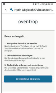
Abb. 4: Menü „Hydr. Abgleich OVbalance Home“ - Einrichtung beginnen
