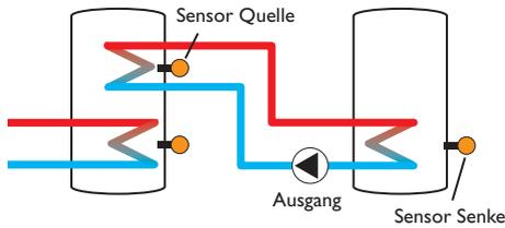
Die **Wärmeaustauschfunktion** dient dazu, Wärme von einer Wärmequelle an eine Wärmesenke zu übertragen.
