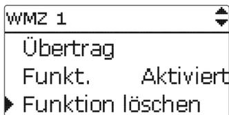
Um einen gespeicherten Wärmemengenzähler zu löschen, Funktion löschen auswählen und die Sicherheitsabfrage mit **Ja** bestätigen. Der Wärmemengenzähler wird gelöscht und steht wieder unter **neuer WMZ...** zur Verfügung.
