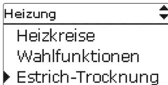
Die Heizkreise können in dem Menü **Heizung/Estrich-Trocknung** ausgewählt werden. Am Ende dieses Menüs kann die Funktion mit **Start** ausgelöst werden.
