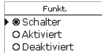
Im Einstellkanal **Funktion** kann eine bereits gespeicherte Wahlfunktion temporär deaktiviert, bzw. wieder aktiviert werden. In diesem Fall bleiben alle Einstellungen erhalten, die zugewiesenen Ausgänge bleiben belegt und können keiner anderen Funktion zugewiesen werden. Die zugewiesenen Sensoren werden weiterhin auf Fehler überwacht.
