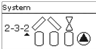
Hier verfügt jedes der Kollektorfelder über ein 2-Wege-Ventil, die Speicher werden über eine Pumpenlogik angesteuert. Für eine Übersicht über die Systeme und ihre Varianten siehe Seite 28.
