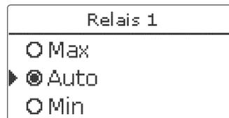
Für jeden Ausgang kann auch einzeln ein Betriebsmodus gewählt werden. Folgende Einstellmöglichkeiten stehen zur Verfügung:
