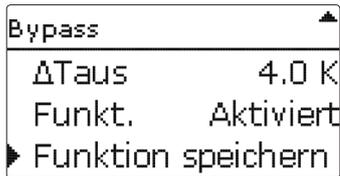
Am Ende jedes Untermenüs zu einer Wahlfunktion stehen die Punkte **Funktion** und **Funktion speichern**. Um eine Funktion zu speichern, **Funktion speichern** auswählen und die Sicherheitsabfrage mit **Ja** bestätigen.
