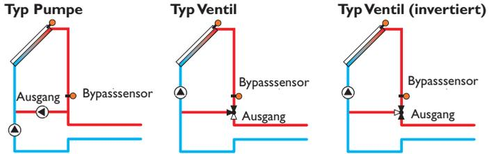
Beispielschemata für die verschiedenen Bypass-Varianten
