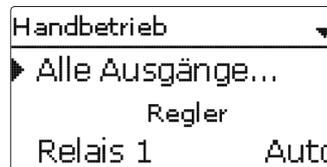
Im Menü **Handbetrieb** kann der Betriebsmodus aller Ausgänge im Regler und in angeschlossenen Modulen eingestellt werden.
