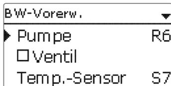
Die **Brauchwasser-Vorerwärmung** dient dazu, mit Wärme aus einem Pufferspeicher den Kaltwasserzulauf des Brauchwasserspeichers zu erwärmen.
