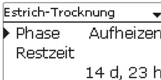
Am Ende des Menüs erscheint statt Start der Menüpunkt **Abbrechen**. Wird Abbrechen ausgewählt, wird die Estrich-trocknung vorzeitig beendet. Aus diesem Grund folgt eine Sicherheitsabfrage. Die Sicherheitsabfrage nur bestätigen, wenn die Estrich-Trocknung abgebrochen werden soll.
