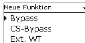
In diesem Menü können Zusatzfunktionen für den Solarteil der Anlage ausgewählt und eingestellt werden.
