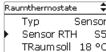
Wenn die Option **Timer** aktiviert wird, erscheint eine Wochenzeitschaltuhr, mit der Zeitfenster für den Betrieb der Funktion eingestellt werden können. Außerhalb dieser Zeitfenster wird die eingestellte Raumtemperatur um den Wert **Absenkung** herabgesetzt.
