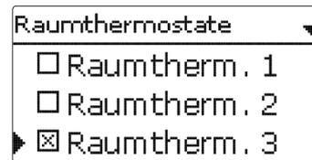
Mit der Option **Raumthermostat** können bis zu 5 Raumthermostate in die Regelung einbezogen werden.
