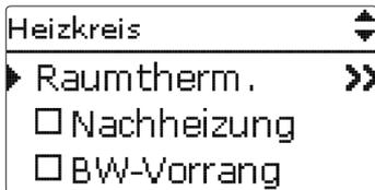
Um die Abweichung der Raumtemperatur von der eingestellten Raumsolltemperatur zu berechnen, benötigt der Regler einen Raumthermostaten. Die Einstellungen dafür können im Parameter **RTH(1 ... 5)** gemacht werden. Dazu **Sensor** im Einstellkanal **Typ** auswählen.
