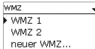
Bereits gespeicherte Wärmemengenzähler erscheinen im Menü WMZ über dem Menüpunkt **neuer WMZ...** in numerischer Reihenfolge.
