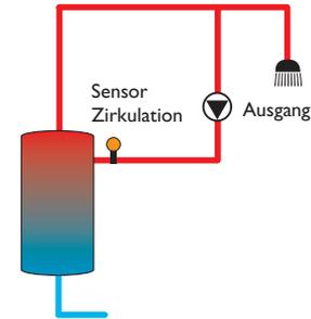
Die **Zirkulationsfunktion** dient zur Regelung und Ansteuerung einer Zirkulationspumpe.
