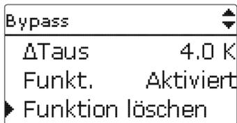
Um eine gespeicherte Funktion zu löschen, **Funktion löschen** anwählen und die Sicherheitsabfrage mit **Ja** bestätigen. Die Funktion steht wieder unter **neue Funktion...** zur Verfügung. Die entsprechenden Ausgänge sind wieder freigegeben.
