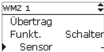
Im Einstellkanal **Funktion** kann ein bereits gespeicherter Wärmemengenzähler temporär deaktiviert, bzw. wieder aktiviert werden. In diesem Fall bleiben alle Einstellungen erhalten.
