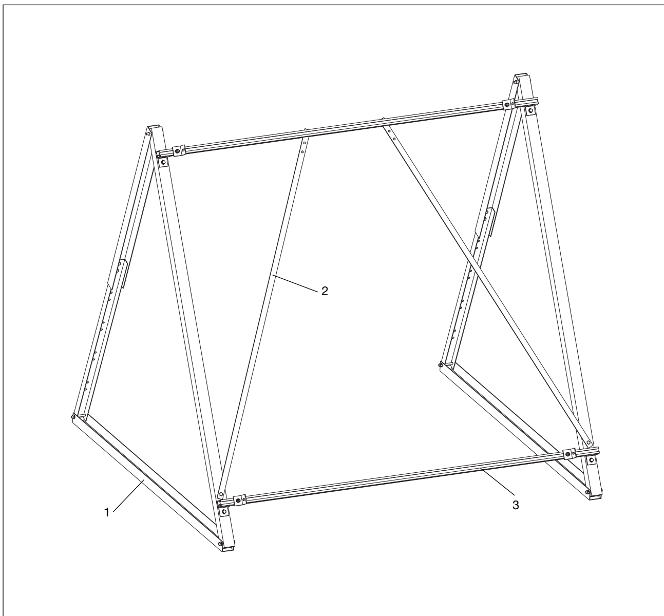
Set de base pour montage sur châssis libre réf. 1361270 et 1361275 (les capteurs ne sont pas fournis avec)
