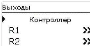
В данном пункте меню для каждого реле контроллера и внешних модулей можно настроить вид управления и минимальное число оборотов.
