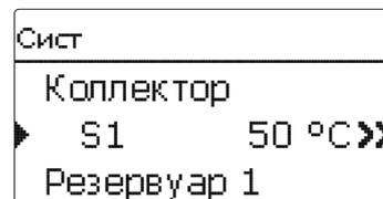
При выборе пунктов Гелиоустановка / система открывается подменю с присвоенными гелиосистеме датчиками и реле. Здесь отображаются текущие температуры или текущее число оборотов.
