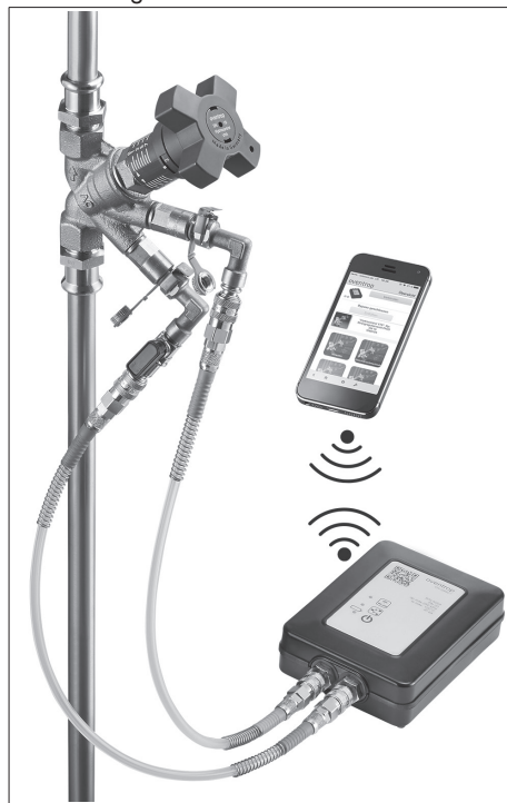
Fig. 6: Exemple de raccordement
