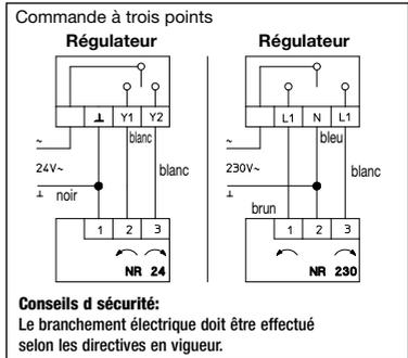
**Instructions pour le montage sur une vanne mélangeuse à trois voies Oventrop:**
