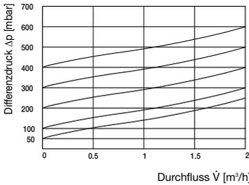
Durchflussdiagramm Bypass DN 32 (Überströmvorrichtung)
