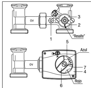
Instalación de válvula de 3-vías de mezcla
