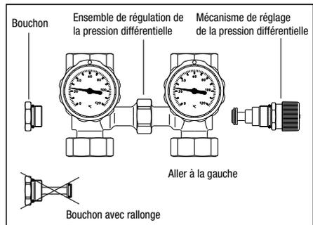
L'ensemble de régulation de la pression différentielle est réglé en usine à une pression d'ouverture de 200 mbars. D'autres pression d'ouverture entre 50 et 400 mbars peuvent être réglées sur la poignée manuelle – lecture sur l'échelle graduée.
