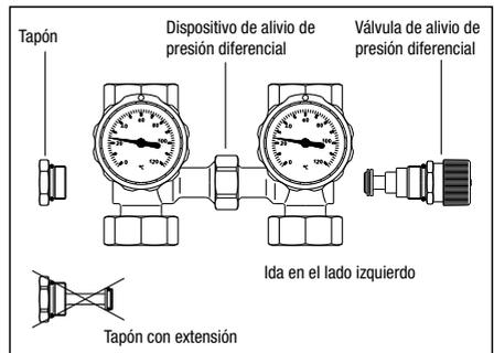
El accesorio de alivio de presión diferencial está preajustado a una presión de apertura de 200 mbar. Es posible ajustar en el volante otra presión de apertura entre 50 y 400 mbar – marcado en la escala.
