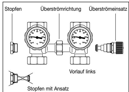
Die Überströmeinrichtung ist werkseitig auf einen Öffnungsdruck von 200 mbar eingestellt. Andere Öffnungsdrücke können am Handrad zwischen 50 mbar und 400 mbar - ablesbar an der Skala - eingestellt werden.
