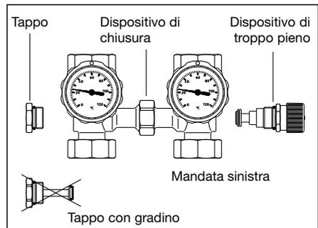
Il dispositivo di troppo pieno dei Regumat SB, M3B e M4B è tarato dalla fabbrica a una pressione di apertura di 200 mbar. Sono impostabili altre pressioni di apertura fra 50 mbar e 400 mbar - leggibili sulla scala -.
