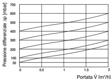
Diagramma di portata Bypass DN 32
