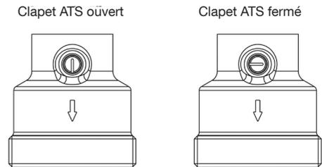
Fig. 3 : Position clapet ATS « Regumat S-180 plus »
