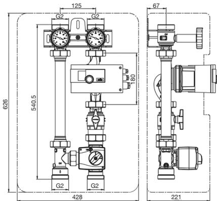
Abb. 2: „Regumat M3-180 plus“ DN32 mit Pumpenkugelhahn
