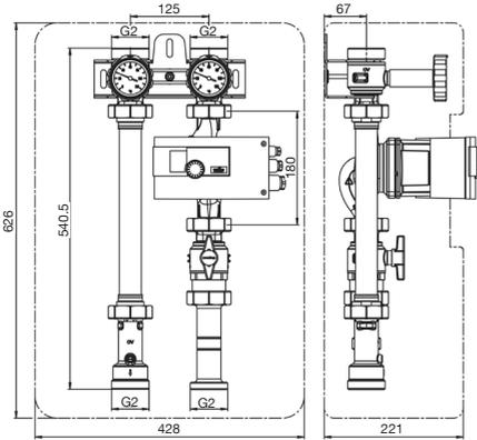
Abb. 1: „Regumat S-180 plus“ DN32 mit Pumpenkugelhahn
