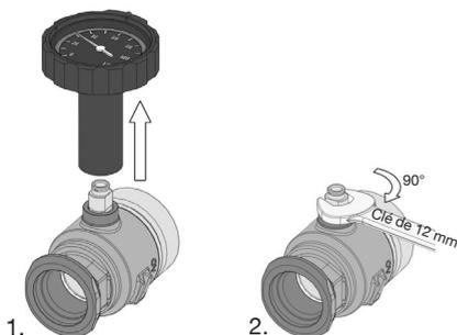
Fig. 21: Fermeture des robinets d'isolement à tournant sphérique
