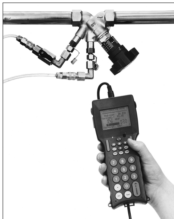
„OV-DMC 2“-drukverschil-meetcomputer, Art.nr. 1069177, met „Hydrocontrol VTR“
