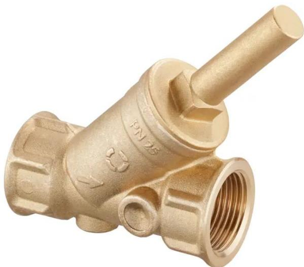
Clapet anti-retour en laiton pour montage horizontal et vertical. Clapet à ressort. Pour installations de chauffage central et de rafraîchissement à circuits fermés et installations industrielles. Ne convient pas à une utilisation en cas de débit pulsatoire ou dans une section de 10 x DN en aval d'un circulateur.
