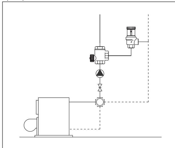
Применение в качестве трехходового вентиля в комплекте с перепускным клапаном (арт. № 108 52) и задвижки для обвязки насоса (арт. № 104 20)
