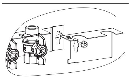
Fixer la plaque de fixation avec la suspension du bloc de raccordement pour robinets à tournant sphérique de la station d'appartement (réf. 1341180) sur l'embase (utiliser les vis et écrous de bloc de raccordement existant).
