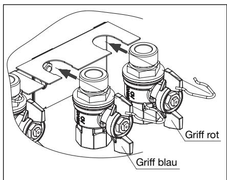
Die Kugelhähne in die Aufhängung der Anschlussleiste einhängen (den Kugelhahn mit rotem Griff in die rechte Einkerbung, den Kugelhahn mit blauem Griff in die linke Einkerbung positionieren)
