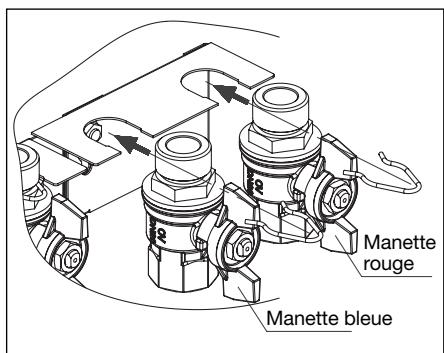
Suspendre les robinets à tournant sphérique au bloc de raccordement (positionner le robinet à tournant sphérique avec la manette rouge dans l'entaille à droite et le robinet à tournant sphérique avec la manette bleue dans l'entaille à gauche). Introduire les clips d'arrêt en dessous de la plaque pour sécuriser les robinets à tournant sphérique.
