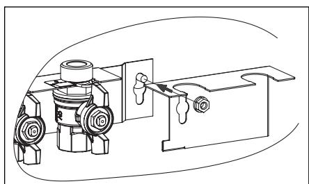
Das Halteblech wird mit der Aufhängung der Kugelhahneileiste der Wohnungsstation (Art.-Nr.: 1341180) an der Grundplatte befestigt (Schrauben und Muttern der vorhandenen Anschlussleiste mit benutzen).
