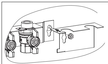
La lamiera viene fissata alla piastra base tramite il gancio della barra valvole a sfera del modulo satellite (codice art. 1341180) (utilizzare la vite ed il dado della barra di collegamento)
