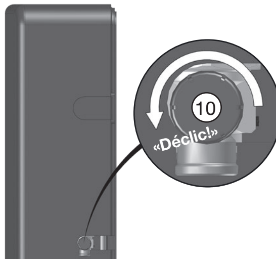
Fig. 6.4: Tourner la soupape de sécurité dans le sens inverse des aiguilles d'une montre
