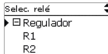
Si el símbolo ☒ se muestra delante de un elemento de menú, al presionar la tecla 5 se abrirá un nuevo submenú. Si ya está abierto, se muestra un ☐ en vez de un ☒.
