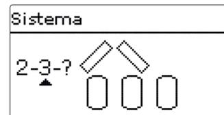
Después se puede elegir la variante hidráulica. La variante se visualiza en la pantalla mediante los símbolos de bomba y válvula. La figura de ejemplo muestra el sistema 2.3.2.
