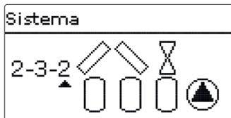
Cada campo de captación dispone de una válvula de 2 vías; los acumuladores se cargan mediante una lógica de carga por bomba. Para una vista general de los sistemas y sus variantes vea página 21.
