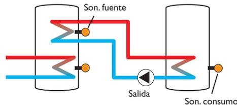
La función **Intercambio de calor** se puede utilizar para transferir calor desde una fuente de calor a un consumo.
