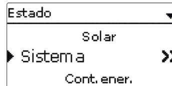
Si el símbolo >> aparece detrás de un elemento de menú, al presionar la tecla 5 se abrirá un nuevo submenú.
