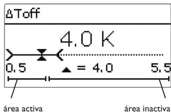
Cuando un parámetro está bloqueado por otro, se mostrará un rango de ajuste reducido según el rango de ajuste del otro valor respectivo.
