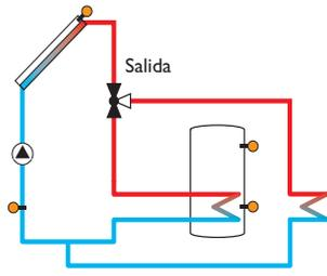
La función **Disipación** del exceso de calor se puede utilizar para dirigir el exceso de calor generado por una fuerte radiación solar hacia un intercambiador de calor externo (fan coil, por ejemplo) para mantener la temperatura del captador a nivel normal.
