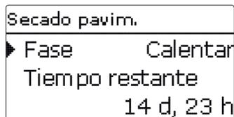
Al final del menú aparecerá el punto del menú **Cancelar** en vez de Inicio. Si se selecciona Cancelar, el secado de pavimento se terminará antes de tiempo. En este caso se muestra una petición de validación. ¡Confirme la petición de validación sólo si realmente desea interrumpir el secado pavimento!
