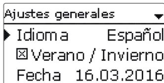
En el menú **Ajustes generales**, se pueden ajustar todos los parámetros básicos del regulador. Normalmente, estos ajustes se habrán realizado durante la puesta en servicio. Se pueden cambiar posteriormente en este menú.
