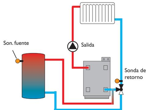
La función **Elevar temperatura de retorno** se utiliza para transferir calor desde una fuente de calor al retorno del circuito de calefacción.
