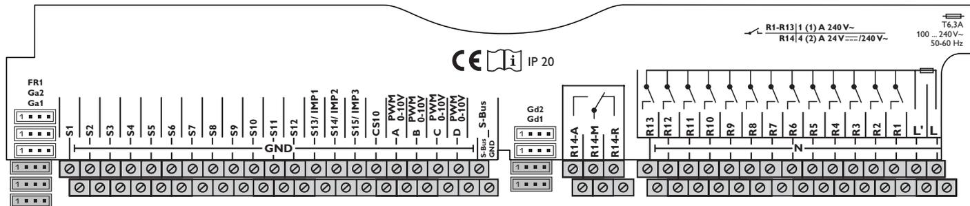
Conecte la sonda de radiación **CS10** a los bornes CS10 y GND con la correcta polaridad. Para ello, conecte el cable marcado con GND al borne común de tierra, y el cable marcado con CS al borne CS10 del regletero.
