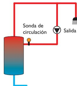
La función **Circulación** se puede utilizar para controlar el funcionamiento de una bomba de circulación.
