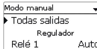
En el menú **Modo manual**, se puede modificar el modo de funcionamiento de todas las salidas del regulador y de los módulos conectados.
