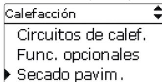
Los circuitos de calefacción se seleccionan en el menú **Calefacción/Secado pavim.**. Si desea activar esta función, seleccione **Inicio** al final del menú.
