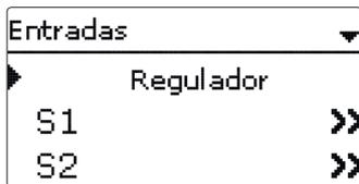
En este submenú, se puede ajustar para cada entrada el tipo de sonda que se ha conectado. Se pueden seleccionar los siguientes tipos:
