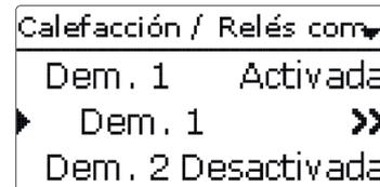
En este punto del menú se pueden realizar los ajustes del generador de calor y que se pueden usar de forma conjunta para varios circuitos de calefacción y sus funciones opcionales.
