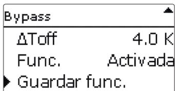
Al final de cada submenú de las funciones opcionales, se encuentran los puntos **Func.** y **Guardar func.** Para guardar una función, seleccione la opción **Guardar func.** y confirme la petición de validación seleccionando **Sí**.
