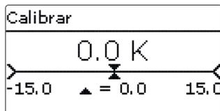
→ Después, ajuste el valor deseado pulsando las teclas ② y ④ y confirme la operación con la tecla ⑤.
