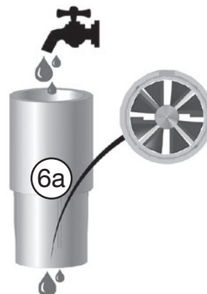
fig. 5.18: Limpie la turbina de medición bajo agua corriente
