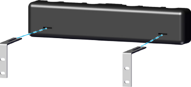
Fig. 4: Position des supports muraux
