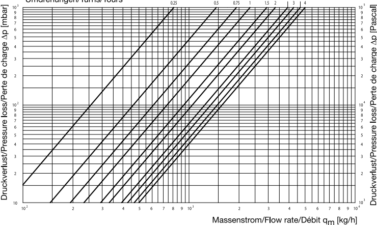
DN 20 ( k_{VS} 5,0) Art.-Nr. / Item no. / Réf. 1068667 Umdrehungen/Turns/Tours
