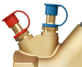
Chaque HydroControl M est équipé de deux robinets auxiliaires HydroPort. Avec les robinets HydroPort, les accessoires peuvent être raccordés facilement et en toute sécurité avec un verrou à déclic. Les robinets HydroPort s'ouvrent par une courte rotation à l'aide d'une clé plate de 13 mm. Pour mesurer la pression, un quart de tour suffit, pour vidanger et remplir, ouvrir jusqu'en butée.
