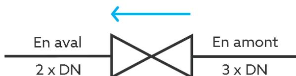
Il faut prévoir des tronçons de stabilisation de 3 x DN amont et de 2 x DN en aval de l'HydroControl M.
