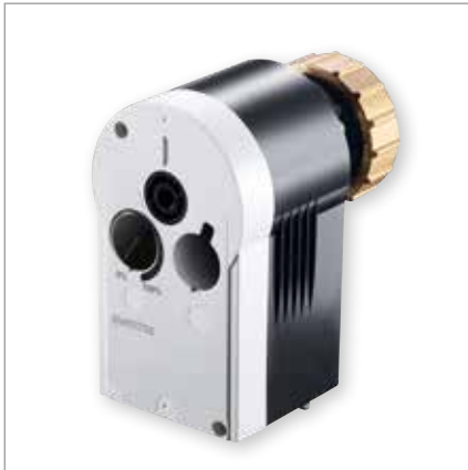
Aandrijving met elektromotor voor modulerende regeling (0-10 V), ook geschikt voor 2- en 3-punts-regeling.
