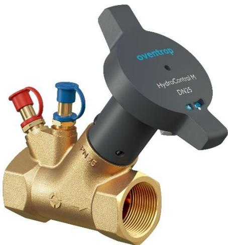
Strangregelafsluiter voor de statische waterzijdige inregeling van leidingnetwerken in gesloten verwarmings- en koelinstallaties. Voorzien van een vaste meetflens voor gecombineerd meten en instellen.
