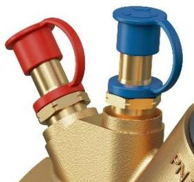
Elke HydroControl M is seriematig voorzien van twee HydroPort multifunctionele aansluitingen. Met de HydroPort kunt u accessoires snel en veilig aansluiten met een klikverbinding. De HydroPort afsluiters worden geopend met een beperkte slag. Een kwartslag is voldoende voor drukmeting, en een volle slag voor het aftappen en vullen.
