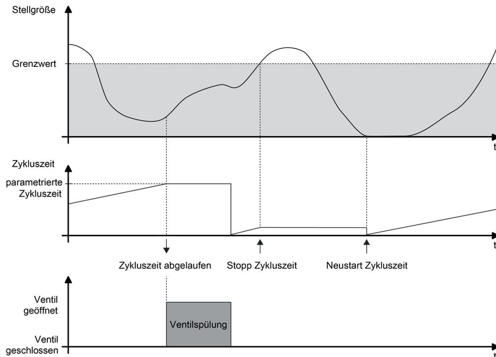
Bild 14: Beispiel eines minimalen Stellgrößen-Grenzwerts für die intelligente Ventilspülung
