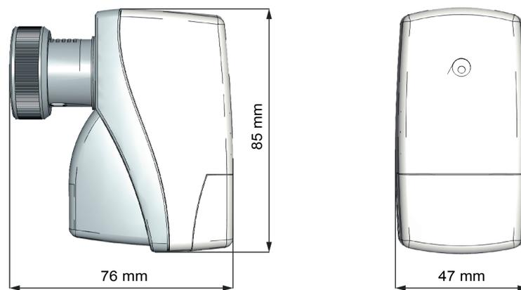
Bild 3: Geräteaufbau, Bemaßung
