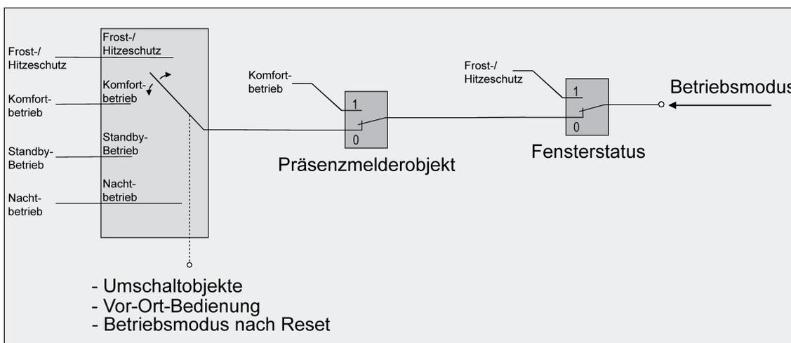
Bild 29: Betriebsmodus-Umschaltung durch 4 x 1 Bit Objekte mit Präsenzmelder
