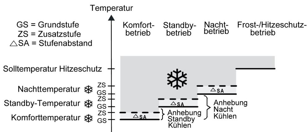
Bild 35: Solltemperaturen in der Betriebsart "Grund- und Zusatzkühlen"
