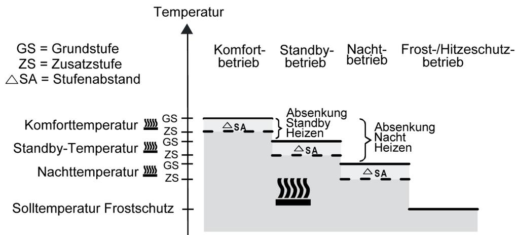
Bild 33: Solltemperaturen in der Betriebsart "Grund- und Zusatzheizen"
