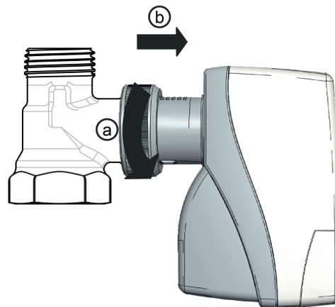
Bild 5: Gerät demontieren
