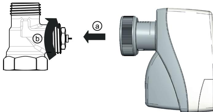
Bild 4: Gerät montieren
