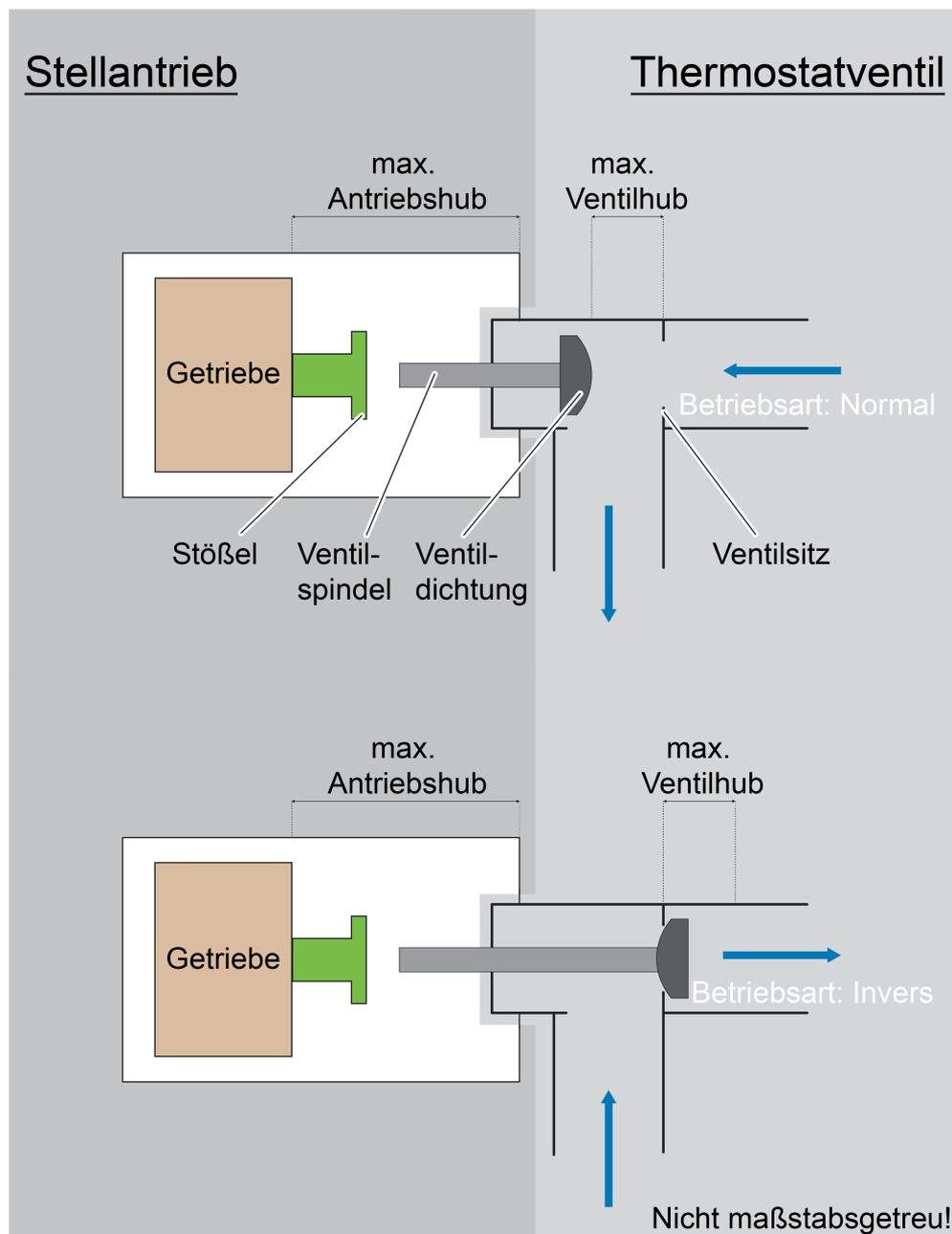
Bild 9: Prinzip-Skizze der funktionalen Einheit
