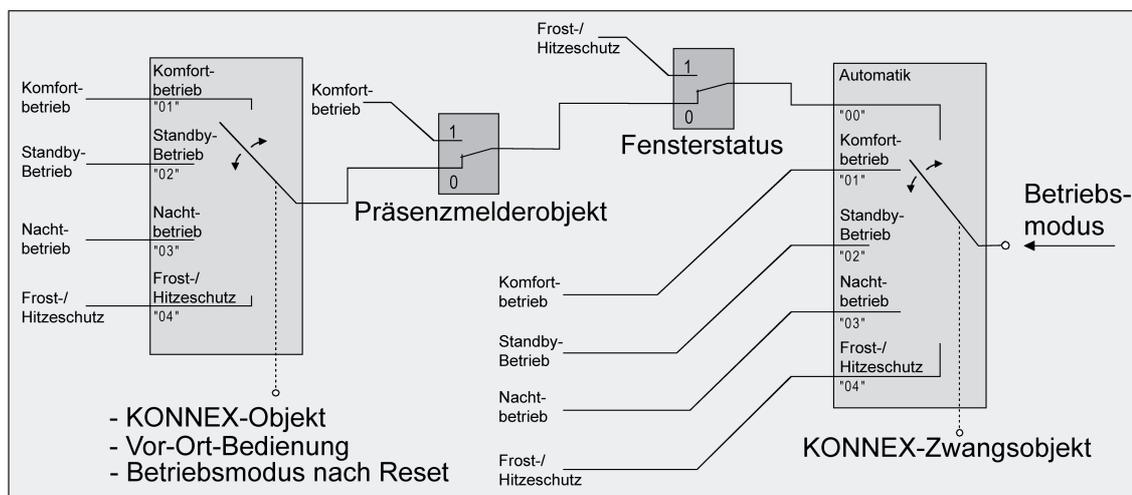
Bild 31: Betriebsmodus-Umschaltung durch KNX Objekt mit Präsenzmelder
