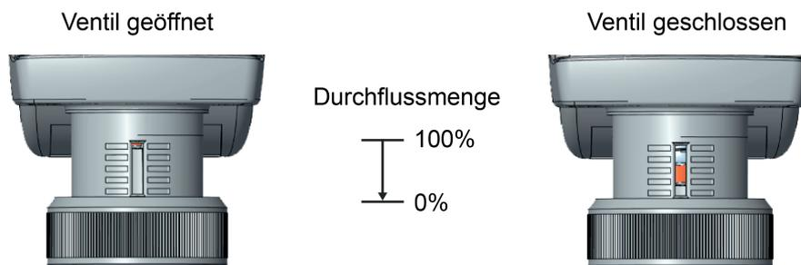
Bild 10: Normal (Stellgröße 0% -> Ventil geschlossen)
