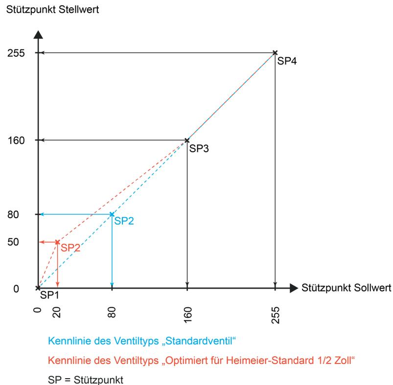
Bild 12: Kennliniendiagramm
