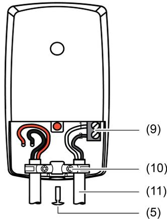
Bild 7: Anschluss eines externen Kontakts / Fernfühler
