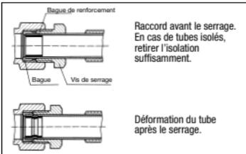
Lors de l'utilisation de tubes à paroi mince et de tubes souples il est nécessaire d'employer des bagues de renforcement. Le tube est alors calibré par la bague et donne la stabilisation intérieure indispensable pour rendre possible le serrage nécessaire. Pour des tubes avec cordons de soudure, des bagues de renforcement ne peuvent pas être employées.
