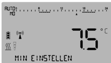
Abbildung 58: (Display-Anzeige Einstellung unteres Temperatur-Limit
