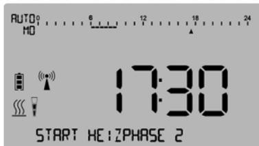
Abbildung 52: Display-Anzeige Startpunkt HEIZPHASE 2
