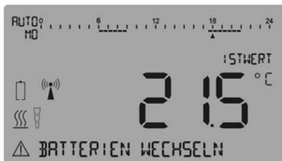
Abbildung 66: Display-Anzeige BATTERIEN WECHSELN
