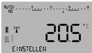
Abbildung 57: Display-Anzeige Einstellung neue KOMFORTTEMPERATUR
