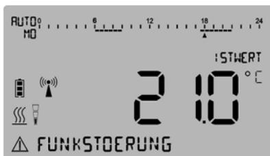
Abbildung 65: Display-Anzeige Störungsmeldung (Textzeile)
