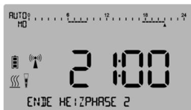
Abbildung 54: Display-Anzeige Endpunkt HEIZPHASE 2
