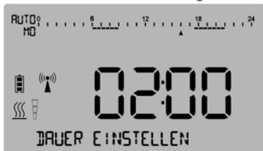
Abbildung 60: Display-Anzeige Dauer PARTYMODUS
