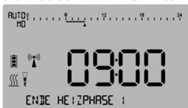
Abbildung 50: Display-Anzeige Endpunkt HEIZPHASE 1
