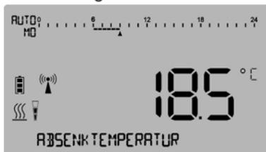
Abbildung 51: Display-Anzeige ABSENKTEMPERATUR HEIZPHASE 1
