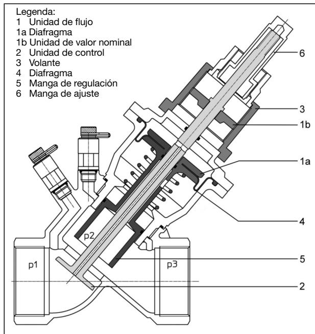
Figura 5 Construcción de la válvula "Cocon QTR"
