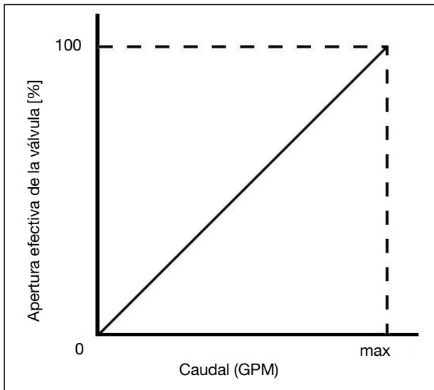
Figura 8 Curva característica de la válvula “Cocon QTR”
