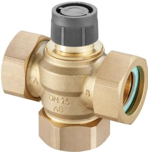
De Tri CTB is een driewegafsluiter die als verdeel- of mengafsluiter kan worden ingezet. Bij gebruik als verdeelafsluiter heeft de Tri CTB één ingang (AB) en twee uitgangen (A en B). Afhankelijk van de instelling van de spindel wordt het medium van de ene naar de andere uitgang geleid.
