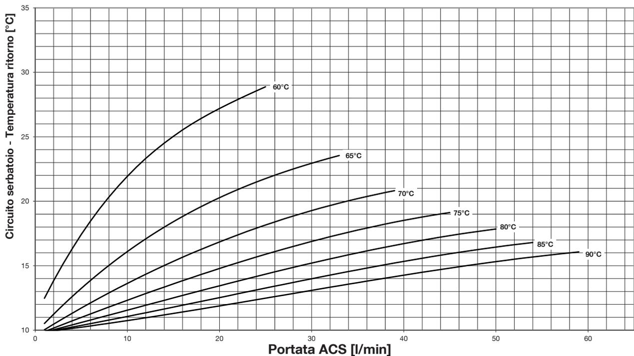
Fig. 46 - Temperatura di ritorno circuito d'accumulo - Riscaldamento dell'acqua potabile a 60 °C
