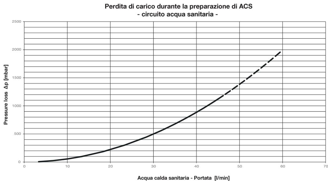
Fig. 38 - Curva caratteristica perdita di pressione durante il riscaldamento dell'acqua potabile (circuito dell'acqua potabile)
