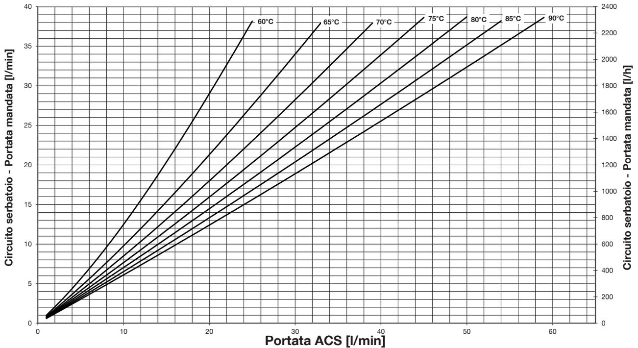
Fig. 45 - Portata in volume del circuito d'accumulo - Riscaldamento dell'acqua potabile a 60 °C
