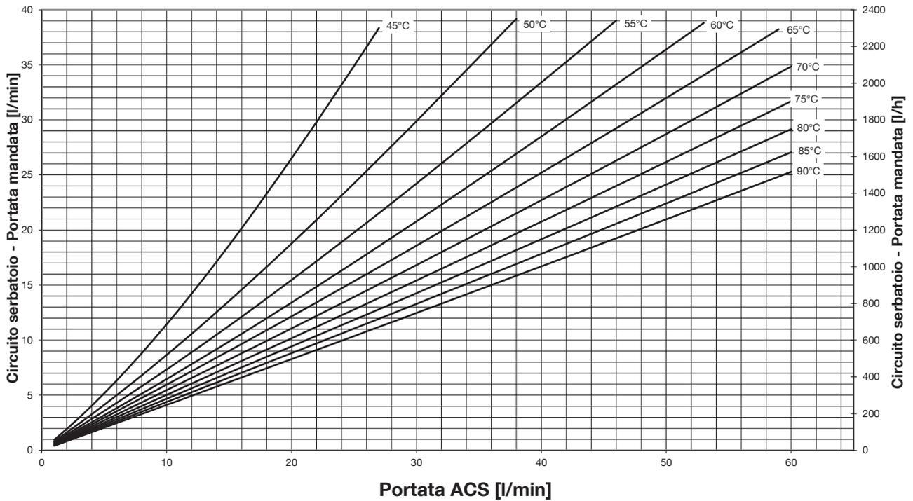
Fig. 39 - Portata in volume del circuito d'accumulo - Riscaldamento dell'acqua potabile a 45 °C
