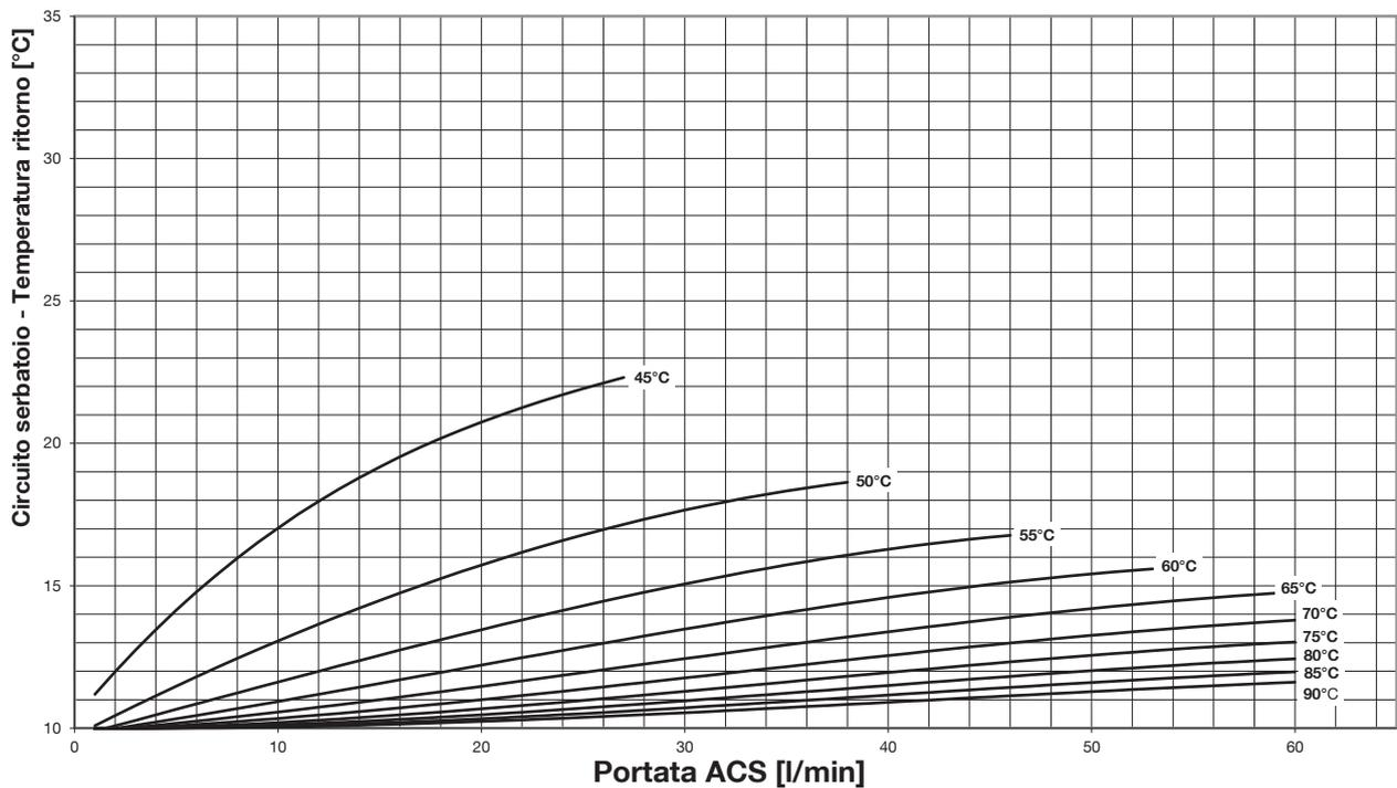
Fig. 40 - Temperatura di ritorno circuito d'accumulo - Riscaldamento dell'acqua potabile a 45 °C
