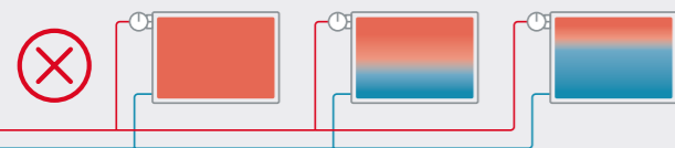
Leistungsschwankungen in Heizungsanlagen ohne hydraulischen Abgleich
