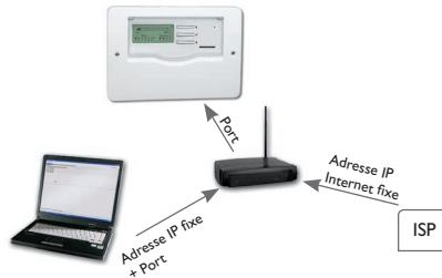
Représentation schématique: Accès à distance au Datalog CS-BS-6, routeur avec adresse IP Internet fixe.
