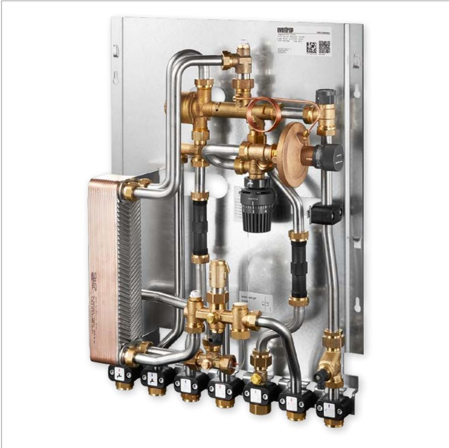
Station d'appartement «Regudis W-HTU» avec échangeur de chaleur pour la transmission de chaleur d'une distribution de chaleur centralisée à l'installation sanitaire et de chauffage d'un appartement
