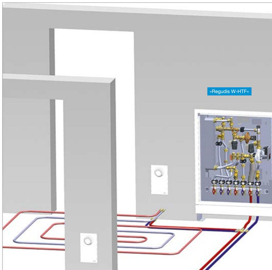
Surface chauffante «Unidis» avec station d'appartement «Regudis W-HTF» avec circuit de chauffage mélangé
