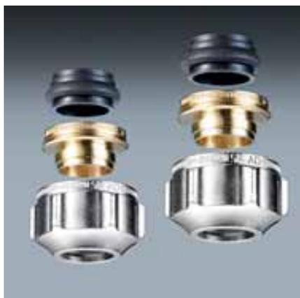
**3** Les raccords «Ofix CEP» sont prémontés pour montage sur chantier (pas de pièces détachées) et peuvent être montés sur le tube sans coincement. Le prémontage se fait en serrant les raccords «Multiflex» à la main. (Le point de séparation de la double bague n'est pas encore coupé en deux).
