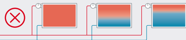
Leistungsschwankungen in Heizungsanlagen ohne hydraulischen Abgleich
