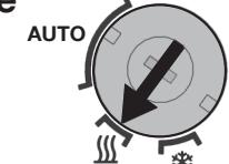
**Heizbetrieb:** dauerhaft Heizen, keine Taupunktüberwachung
