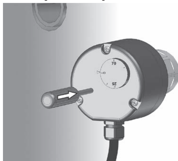
Figure 17: Déblocage à l'aide d'un tournevis
