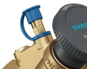
Chaque HydroCom A est équipé d'un robinet auxiliaire HydroPort. Avec l'HydroPort, les accessoires peuvent être raccordés facilement et en toute sécurité avec un verrou à déclic. Le robinet HydroPort s'ouvre par une courte rotation. Un quart de tour suffit pour mesurer la pression, un tour complet suffit pour vidanger et remplir.
