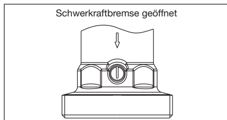
Abb. 6.7 Befüllen der Anlage
