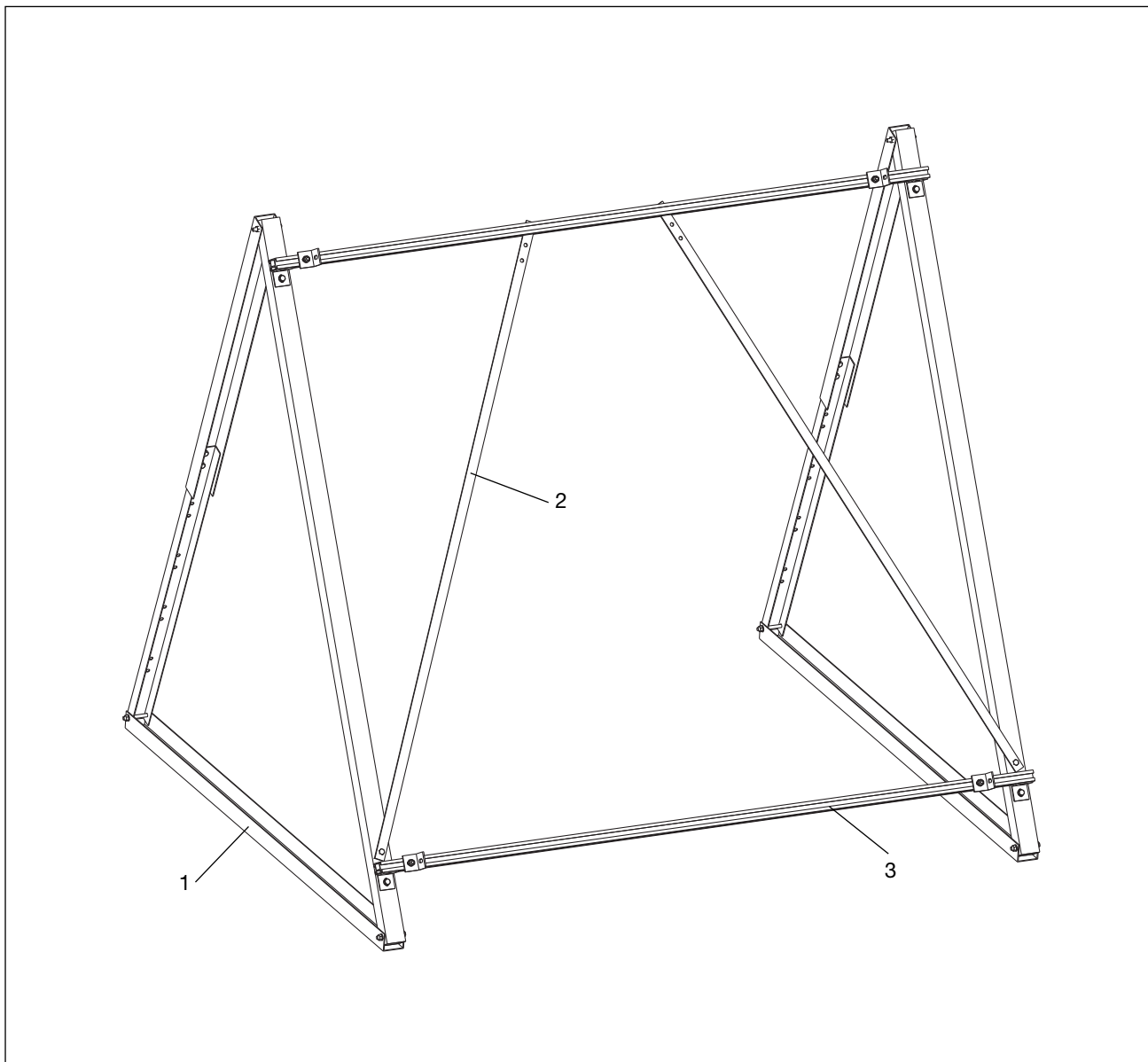
Grundset Aufdachmontage Art.-Nr. 1361270 und 1361275 (Kollektoren nicht im Lieferumfang enthalten)
