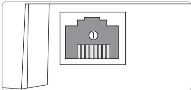
El puerto LAN ① integrado se sitúa en la parte izquierda del Datalog CS-BS-1 y soporta velocidades de transmisión de 100 MBit por segundo.
