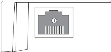
Die integrierte LAN-Buchse (1) befindet sich an der rechten Seite des Datalog CS-BS-1 und unterstützt Transferraten von bis zu 100 MBit pro Sekunde.
