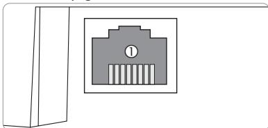
Le connecteur LAN ① intégré se trouve sur le coté droit de l'appareil; il supporte des débits de transfert de jusqu'à 100 MBit par seconde.
