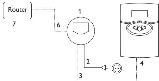
Die Stromversorgung erfolgt über ein externes Steckernetzteil (Klemmen 1 und 2). Die Versorgungsspannung des Steckernetzteils muss 100 ... 240V~ (50 ... 60Hz) betragen.
