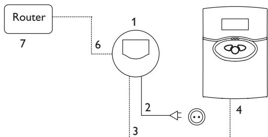
L'alimentation électrique s'effectue à travers un adaptateur secteur externe (bornes ❶ et ❷). La tension d'alimentation de l'adaptateur secteur doit être comprise entre 100 et 240 V~ (50 ... 60 Hz).
