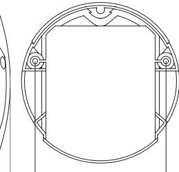
Posición de los orificios de fijación
