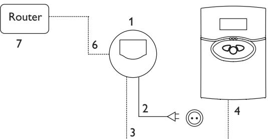
Il modulo viene alimentato da rete elettrica con un alimentatore esterno (morselli 1 e 2). La tensione elettrica dell'alimentatore deve essere di 100...240 V~ (50...60 Hz).
