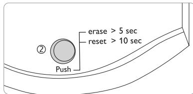
La tecla reset ② en la que está integrado el piloto de control LED permite restablecer los ajustes de fábrica del Datalog CS-BS-1.
