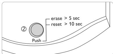
Der Reset-Taster (2) ist in die Betriebskontroll-LED integriert. Mit dem Reset-Taster kann die Konfiguration des Datalog CS-BS-1 auf die Werkseinstellungen zurückgesetzt werden.
