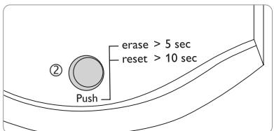
Il tasto reset ② nel quale è integrata la spia di controllo LED consente di resettare la configurazione del Datalog CS-BS-1 alle impostazioni di fabbrica.
