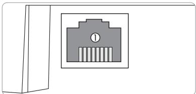
La porta LAN ① si trova nella parte destra del Datalog CS-BS-1 e supporta velocità di trasferimento di fino a 100 MBit al secondo.
