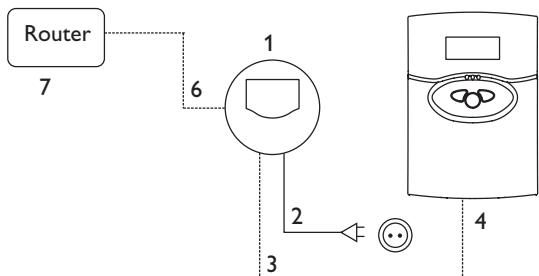
El equipo se debe alimentar a través de una fuente de alimentación externa (bornes ❶ y ❷). La alimentación del equipo tiene que ser 100 ... 240V~ (50 ... 60Hz).
