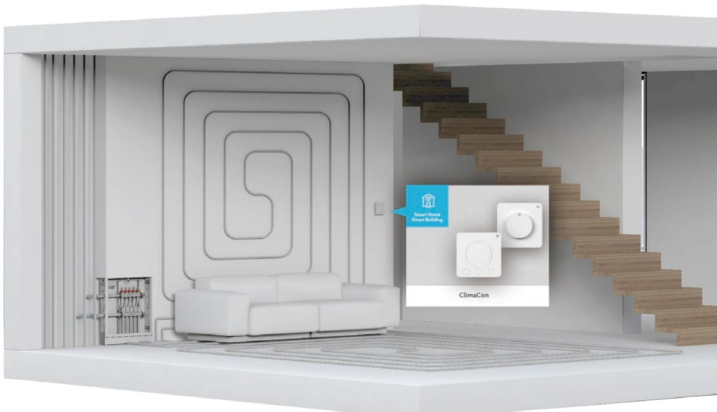
Fig. 1: Schéma d'installation (exemple)
