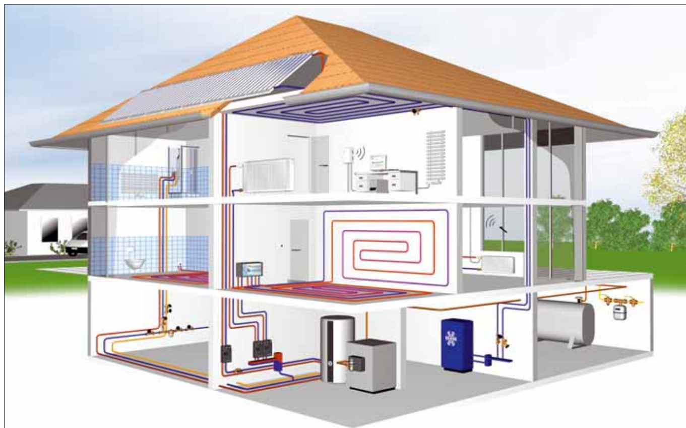
Příklad: Výstavba solární soustavy v rodinném domku
